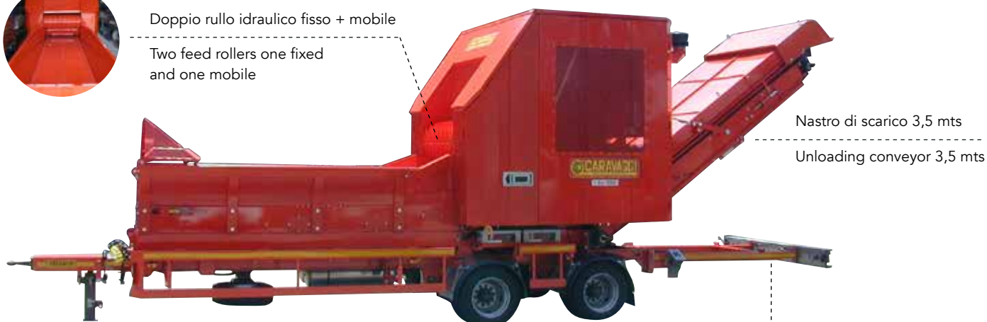
Carrello stradale omologato con freni e sistema abs
