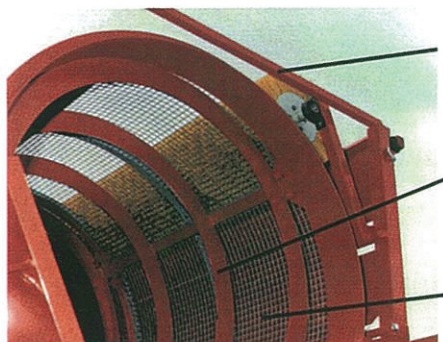
Spazzola per la pulizia automatica delle griglie
