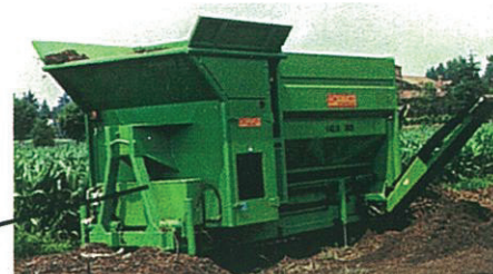
Allestimento su slitta scarrabile
