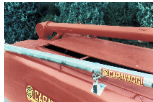
Portello superiore di carico e coclea di recupero
