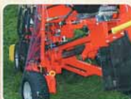
Ruote frontali regolabili in larghezza Roues frontales réglables en largeur
