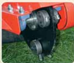
Disco ad 8 utensili "Carbide" Tête à 8 pointes "Carbide"
